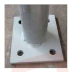
Auf Wunsch erhalten Sie den Pfosten mit angeschweißter Fußplatte ( $140 \times 120 \times 8$  mm, inkl. 4 Bohrungen Ø 14 mm). Bodenverankerung muss bauseits erfolgen (Empfehlung: Injektionssystem mit Fischer-Anker FIS A/RG M12x260).
